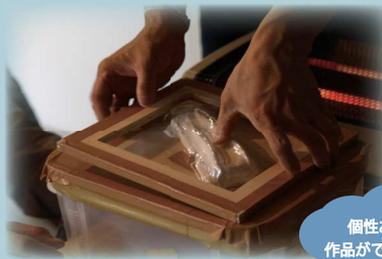
機材は家にあるものでも、正確に時間を計り、素早く作業する姿は町工場そのもの。樹脂シートを家庭用ヒーターで温めて、ぎゅっと紙粘土の型にくっつけて、家庭用掃除機で空気を吸い込むと、シートが立体的に真空形成された型に色付けをし、額に挟んで完成。
